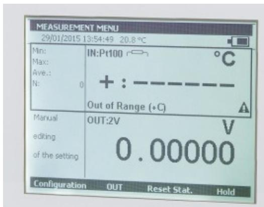
CALYS 1200 permet de sélectionner le nombre de chiffres après la virgule: Cette fonction se justifie en fonction des besoins de chaque utilisateur, qui souhaite ou non afficher la meilleure résolution du signal dans le cas d'étalonnages, ou au contraire la limiter afin de procéder simplement à des vérifications.
